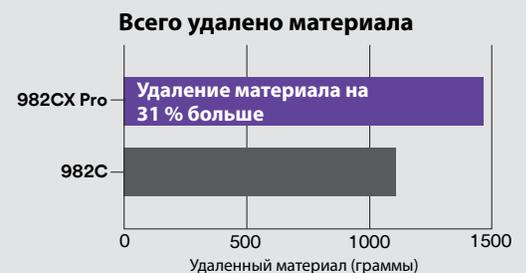
\*Результаты получены в ходе автоматизированного 11-минутного испытания на стали марки 1018 при использовании фибровых кругов 3M™ Cubitron™ II 982CX Pro, 7 дюймов с зернистостью 36+ и ребристыми оправками для кругов 3M™ 64862 на серводвигателе.
