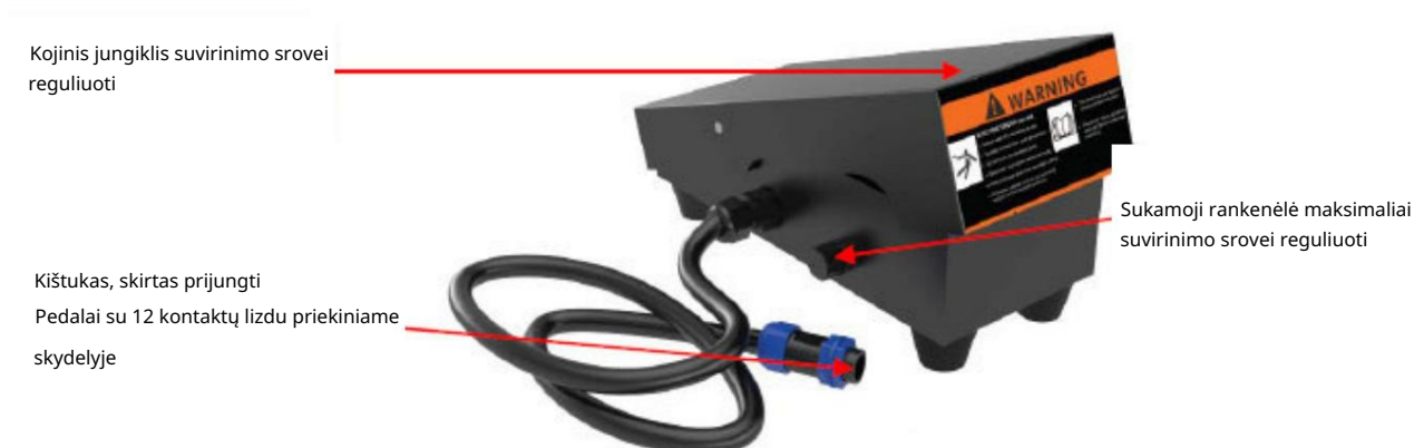
6-8 pav.: Srovės valdymas kojiniu jungikliu
