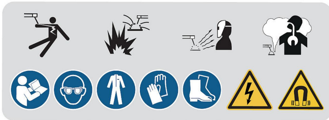
Att.1-1: Drošības marķējumi uz plazmas griešanas sistēmām
