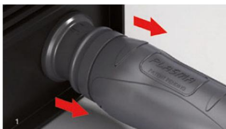
Att.4-3: Atskrūvējiet degļa savienojumu
