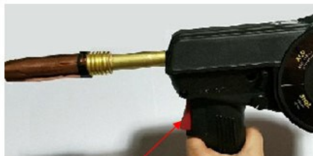
11. Juhtme eemaldamiseks tõmmake päästikut mööda kaela alla, kuni see väljub kontaktotsast.
