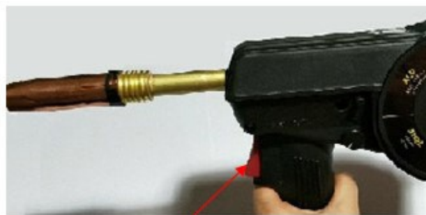
11. Nospiediet sprūdu, lai noņemtu vadu lejup pa kakliņu, līdz tas iziet no kontakta uzgaļa.
