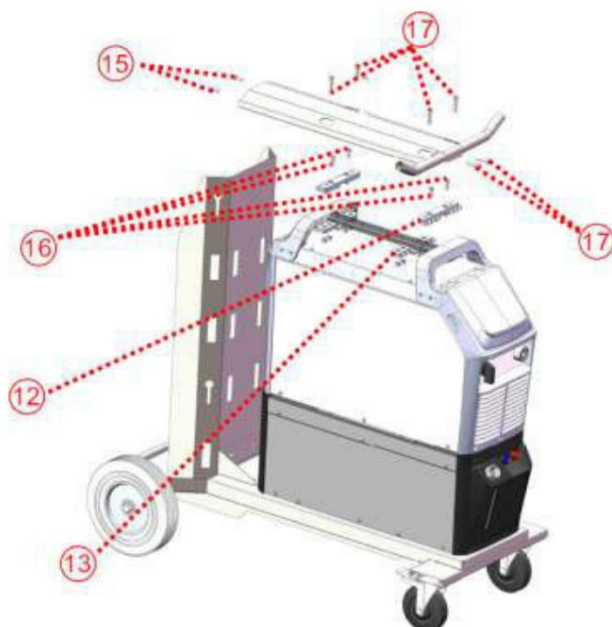
Joonis 9-5: Traadi etteandeseadme paigaldamine
