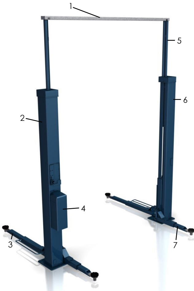
Bild 21: Montage Gesamtbild ohne Steigrohrverlängerung
