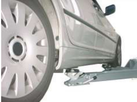
Figura 1: Posicionar los platos portantes debajo de los puntos de elevación solicitados por el fabricante del vehículo.
