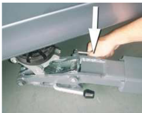
Immagine 3: Per sbloccare i piatti di alloggiamento bisogna premere la leva inferiore.
