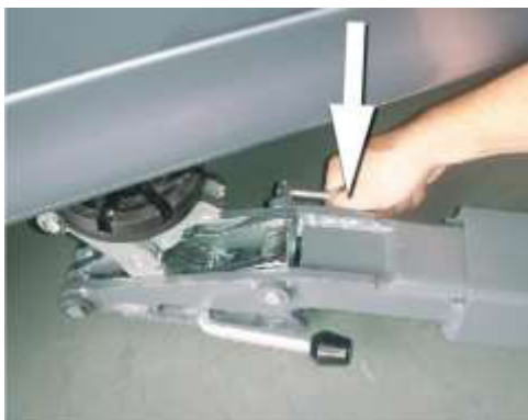
Figura 3: Para desencajar los platos de elevación se deberá presionar la palanca posterior.
