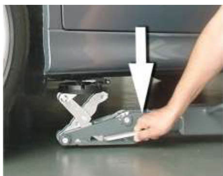
Immagine 2: Eventualmente applicare i piatti portanti premendo la leva sui punti di alloggiamento.
