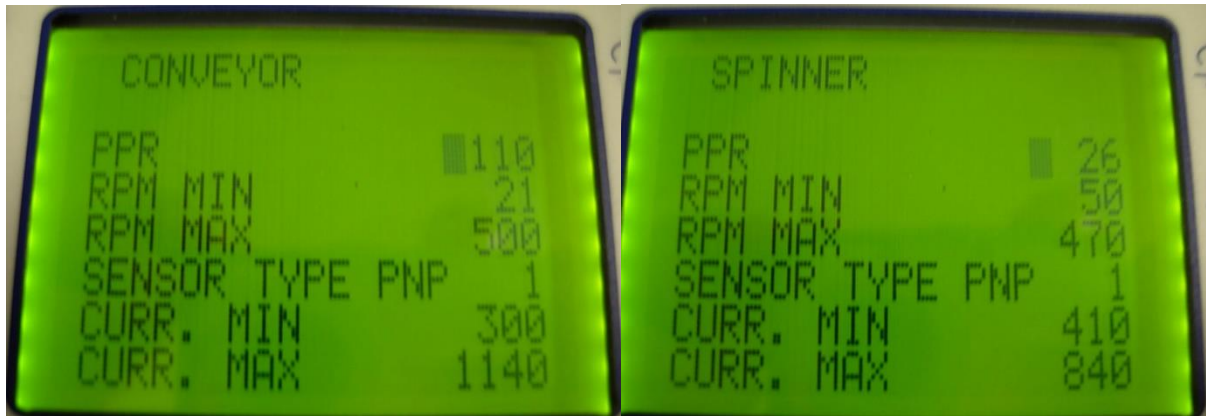
Figure 10. Hydraulic motor parameters. (SIIA TULEVAD UUED PILDID MEIE ANDMETEGA)
