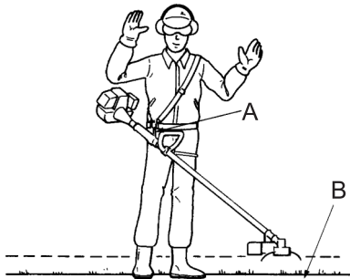
Līdzsvarošanas rīks, kas nodrošina griezējgalvas rotāciju horizontālā plaknē
