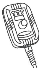
RC 100 aygıtı kaynak akımının ve voltajının görüntülenmesi ve ayarlanması için kullanılan bir uzaktan kumanda cihazıdır.
