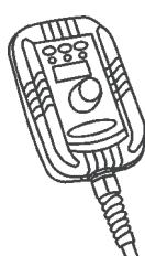
Układ zdalnego sterowania RC 100 umożliwia wyświetlanie i regulację napięcia i natężenia prądu spawania.
