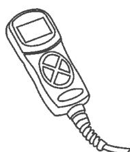
Ovladač RC 200 zobrazuje a jeho prostřednictvím je možno nastavovat a měnit všechny parametry, které jsou na ovládacím panelu zařízení ke kterému je připojen.
