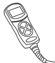
RC 200 aygıtı bağlılığı güç kaynağı kontrol panelindeki bütün parametrelerin görüntülenmesine ve değişmesine olanağ sağlayıcı bir uzaktan kumanda cihazıdır.
