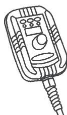
RC 100 je diaľkový ovládač so zobrazením nastavenej hodnoty zváracieho prúdu a napäťia.
