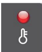
21. att. Stāvoklis pārkaršanas aizsardzības sistēmas aktivizēšanās gadījumā
