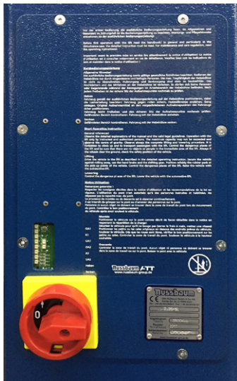
Immagine 4 Unità di sollevamento con commutatore-invertitore (2.30 SL fino a 2.40 SL)
