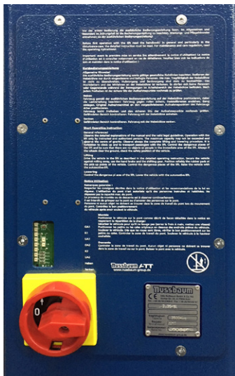
Figura 4: Unidad de mando con conmutador inversor (2.30 SL hasta 2.40 SL)
