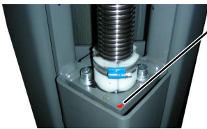
Immagine 18: Applicare dello smalto sigillante sul perno della madrevite di sollevamento
