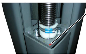
Bild 18: Hubmutterstift mit Siegelack versehen
