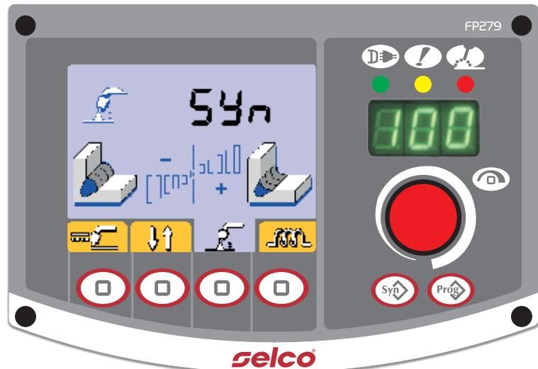
È disponibile una raccolta di 14 programmi sinergici per arricchire il lavoro di saldatura in modo semplice ed intuitivo. Basta entrare nel menu SYN, selezionare il materiale di interesse e il diametro del filo, e si inizia subito a saldare in sinergia.
