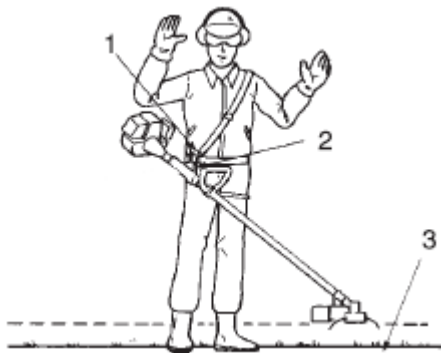
Subalansavimas, kad pjovimo galvutė suktųsi horizontalioje plokštumoje
