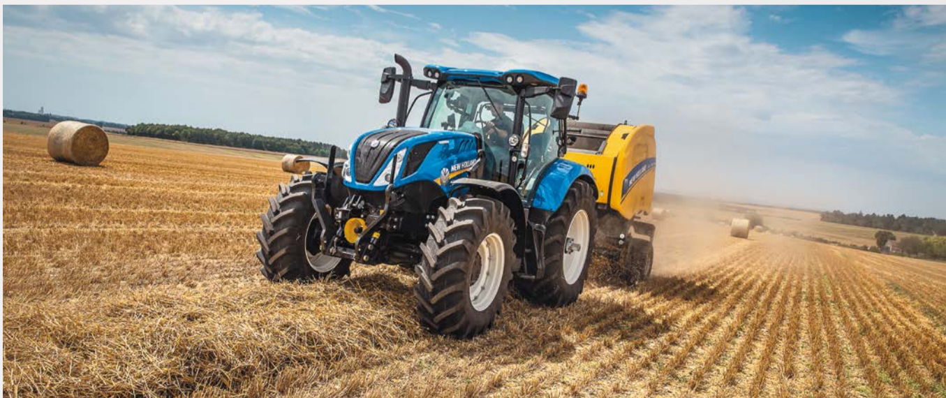
» T6.175 dzinēja nomināljauda: 175 ZS. Transmisija: 24X24/ 8 pakāpju DYNAMIC COMMAND™
